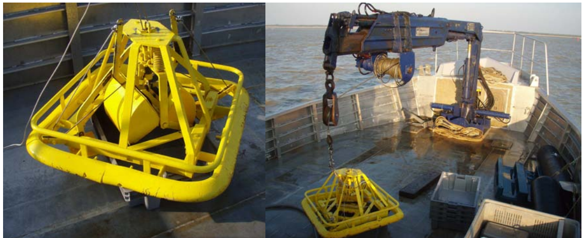
Figure C.2.2 Benne Smith Mc Intire utilisée pour les prélèvements et vue de la benne montée sur le bras télescopique
